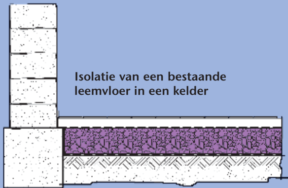
Misapor als isolatie onder vloerverwarming en tegelvloer
